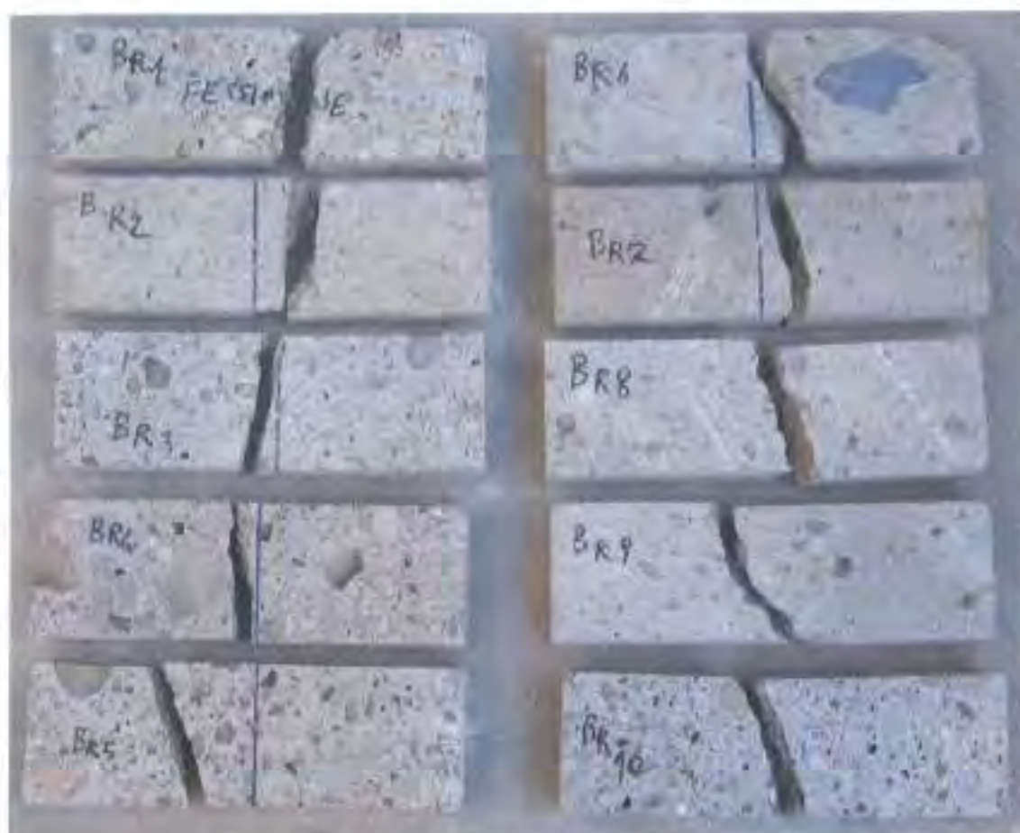
Figura 8 - Frattura in mezzzeria di provini sottoposti a prova di flessione
