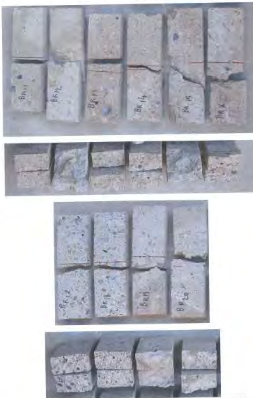
Figura 12 - Provini sottoposti a prova di flessione dopo i cicli di gelività
